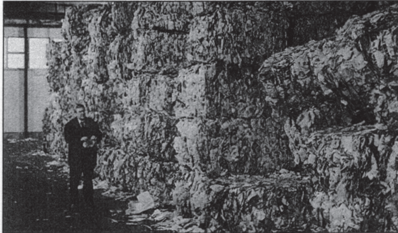
Käytetyt nestepakkaukset tuodaan Saksasta laivalla Varkauteen 500 kilon paaleissa. Vuosittain pakkauksia tulee noin 40 laivalasti. Suuressa rummussa erotetaan käytettyjen nestepakkausten käyttökelpoinen kierrätyskuitu lämpökattilalla ohjattavasta muovi- ja alumiinjätteestä, jonka osuus on noin 25 prosenttia.
